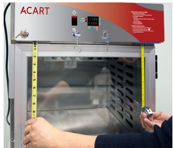
Fig. 69: Check Alignment- Square Door
