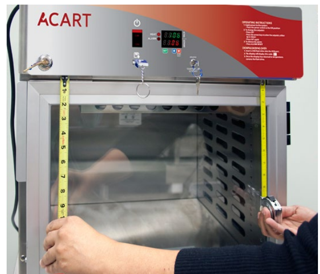
Fig. 56: Check Alignment- Square Door
